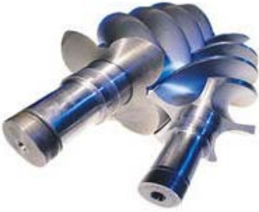
Dörde Beş Asimetrik Profilli Rotorlar (CompAir, 7-13 bar Yağlı Vidalı Kompresör için )
